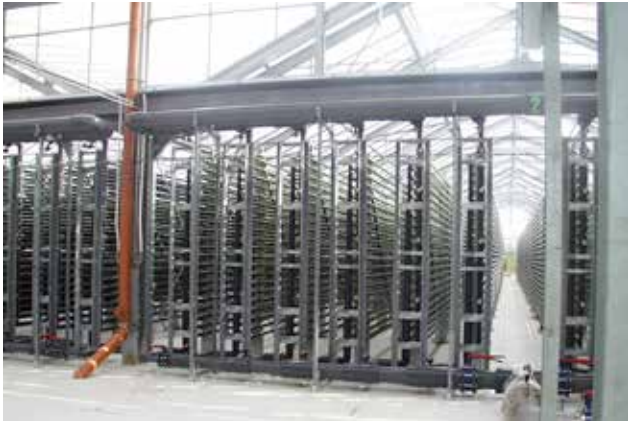
Die Grünalgen-Produktion findet in lichtdurchlässigen Röhren statt, in dem der Wasser-Algenbrei bis zur Reife zirkuliert
