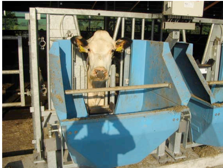
Verwiegetröge zur Messung der täglichen tierindividuellen Futtermittelaufnahme
