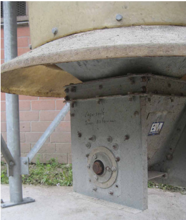
Eine große Abdeckhaube unter dem Silotrichter sorgt für eine trockene und sichere Futterentnahmetechnik.
