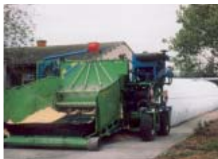
Zur Befüllung des Folienschlauches stehen verschieden große Maschinen zur Verfügung
