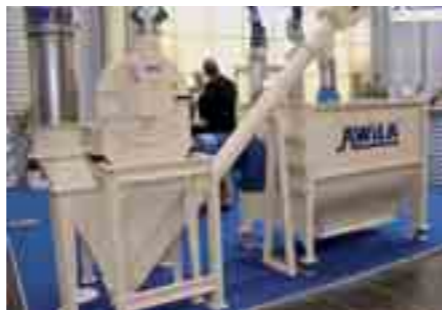
Mahl- und Mischanlage mit „liegendem Mischer“ und mechanischer Förderung
