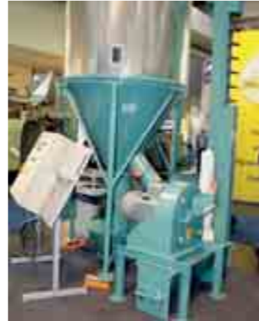
Gewichtsdosierende Mahl- und Mischanlage mit mechanischer Fördertechnik (links)
