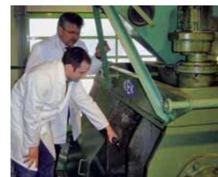
Mike Meisberger und Günter Hell kontrollieren die Öltemperatur während des Pressvorgangs
